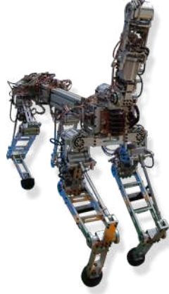
ARAT-1 4 Ayaklı Robot Projesi 1. Prototip
